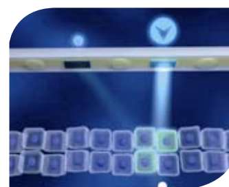
Σχήμα 2. Όταν η μισή ποσότητα ρεύματος φτάνει στο κάθε ηλεκτρόδιο, η εστία διέγερσης είναι ανάμεσα στα ηλεκτρόδια και στους νευρώνες που διεγείρονται.
